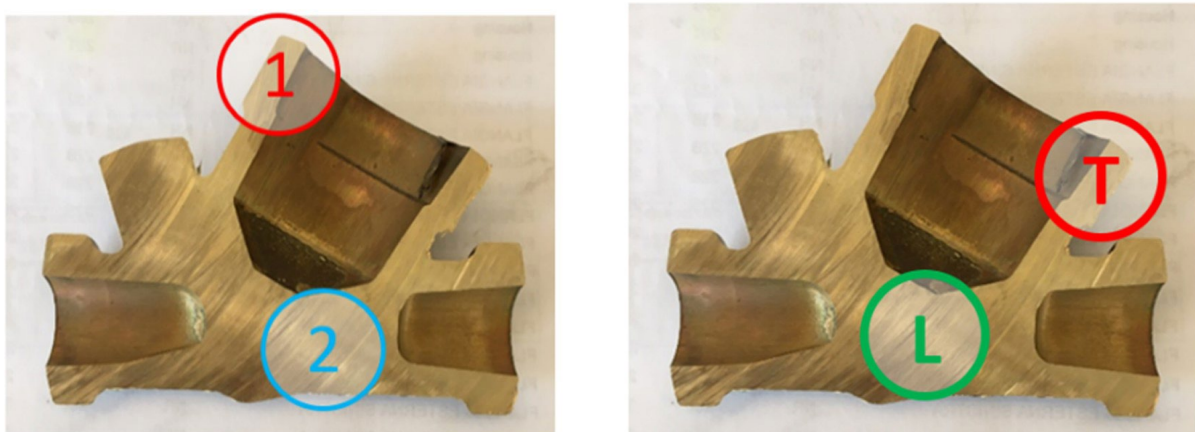
Fig.3 - I provini metallografici per l'analisi della fase β sono stati ricavati dalle zone 1 e 2 mentre i provini per i test di dezincificazione sono stati prelevati dalle zone T (Trasversale) e L (Longitudinale) / The β phase analysis were obtained from metallographic analysis of zone 1 and zone 2, while the samples for the dezincification tests were taken from the T (Transversal) and L (Longitudinal) zones.
